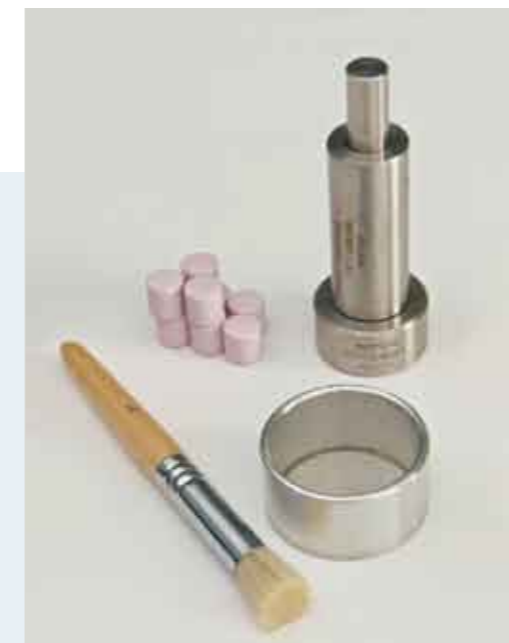
如果样品初始颗粒大于 0.5mm, 可以使用样品制备工具来进行粉碎
