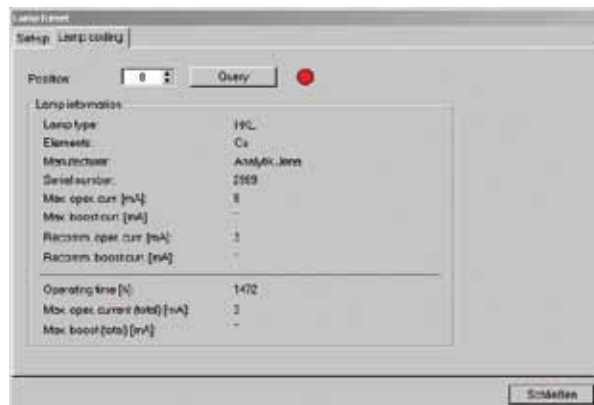
▲ Display of coded lamp parameters
