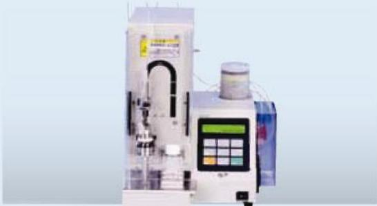
连接数字式密度计，由数字式密度计控制操作程序。
