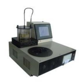
ARH-1 型自动软化点试验仪是本公司开发出来的最新产品。仪器适用于 GB/T 4507-1999 《沥青软化点测定法 (环球法)》和 ASTM D36 / D36M - 09 《Standard Test Method for Softening Point of Bitumen (Ring-and-Ball Apparatus)沥青软化点试验方法(环球法)》. 具有可测试项目多、自动化程度高等优点,广泛适用于石化、塑料等行业。
