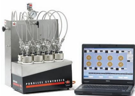
8×75ml 高压反应系统, 进气/排气电磁阀软件控制, 悬停式磁力搅拌
