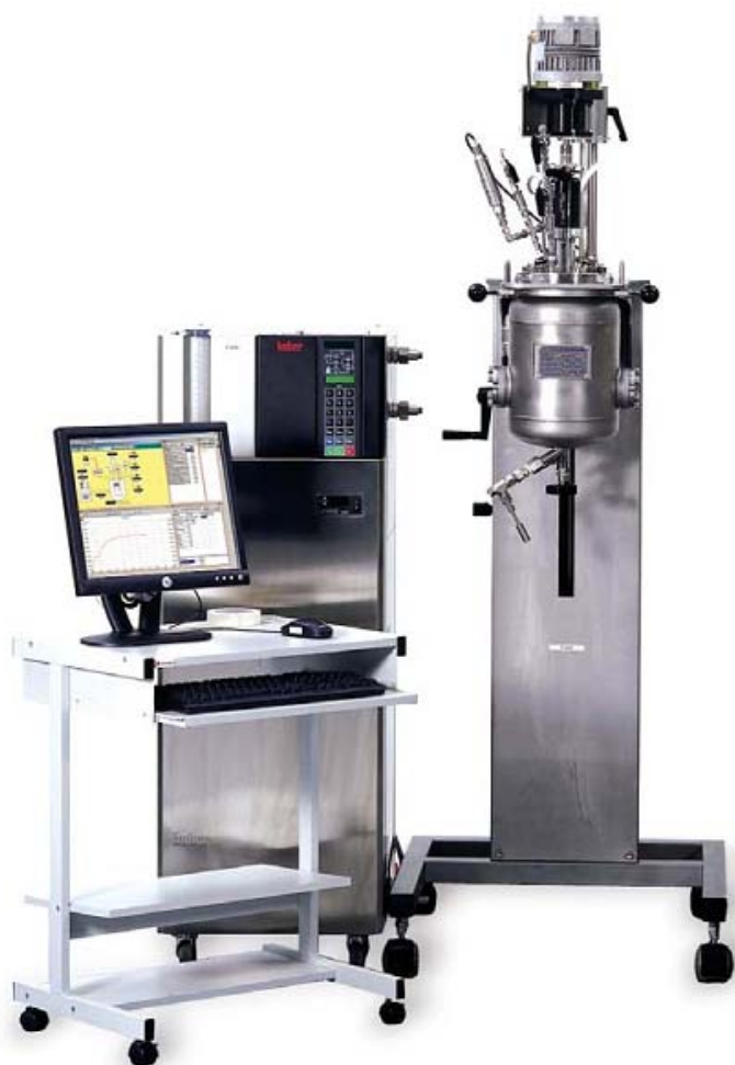
20L 高压反应釜，带油浴循环夹套和液压自动升降装置
