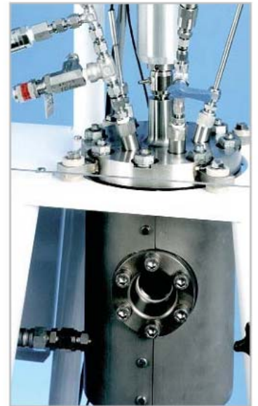
带玻璃视窗的高压反应釜
