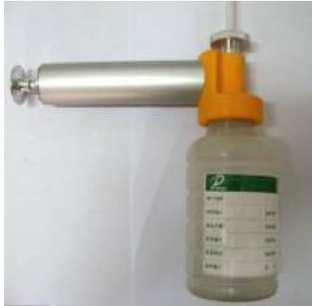
为获取代表性油样，推出了手动取样泵、取样管和油样瓶等一套组合取样工具。取样泵取样过程如下：（1）将油样信息填写到油样标签上，然后将标签粘贴到油样瓶上；（2）将油样瓶旋紧在取样泵上，然后拧松取样泵上的螺母，将合适长度的外径为6毫米取样管插入到油样瓶约3/4高度处，拧紧螺母以夹住取样管；（3）将取样管另一端插入到油箱合适高度，反复拉动取样泵的活塞杆以不断形成真空，将油液吸入油样瓶中；（4）当油液高度快到油样瓶标志处时，拧松取样泵上的螺母使瓶中气压恢复到大气压，油液停止流动；（5）拧下油样瓶，盖上瓶盖。然后从取样泵上取出取样管，擦拭取样器被污染部位以备下次使用。注意每次取样时应更换新的取样管。
