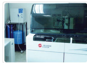
（实例：向生化仪供水）
