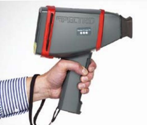
无需进行复杂的样品制备，手持式能量色散X射线荧光光谱仪（HANDHELD EDXRF）对复杂基体的环境类样本提供非常快速直接的元素测量和光谱化学成分分析，SPECTRO xSORT光谱仪可以在极短的时间内达到非常低的检测下限，因此在现场测试中可以快速提供实验室等级的测试结果。
