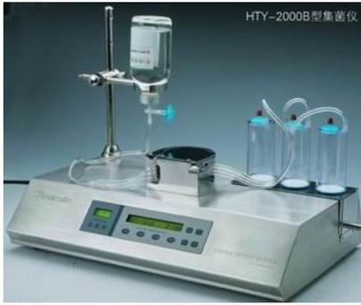
HTY 集菌仪是一次性使用全封闭集菌培养器的配套使用设施, 供试品通过集菌仪的定向蠕动加压作用, 实施正压过滤并在滤器内进行培养, 以检验供试品是否含菌。供试品通过进样管道连续被注入集菌培养器中, 利用集菌培养器内形成的下压, 通过 0.45um 孔径的滤膜过滤, 供试品中可能存在的微生物被截留收集在滤膜上, 通过冲洗滤膜除去供试品的抑菌成分。然后把所需培养基通过进样管道直接注入集菌培养器中, 放置规定的温度培养, 观察是否有长菌现象。
