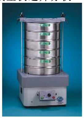
Endecotts PowerMatic 型筛分机是针对大样品而设计的,可承载直径 450mm 的筛网; 2 个以精确角度安装的马达,可将振动频率完全传送至样品,特别是利于处理密度小的样品,避免一些振动器振动效果不佳而产生误差。特殊刹车在停机前自动启动以避免系统超转,坚固结构使运作十分安静。PowerMatic 可装置 5 组筛网, 1 组盛盘及上盖。分离式面板,可在桌面、墙壁或其他位置进行操作,独立安全断电可确保装卸设备的人身安全。
