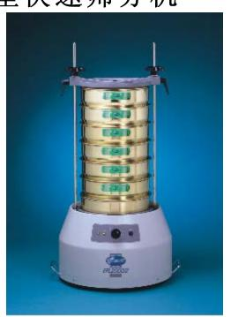
Endecotts EFL2000 是针对大量散装样品所设计的高负载型筛分机。强力振动器可确保将振动能量输送至筛网,固定频率的垂直运动,提高样品通过筛网的效率,缩短筛分时间。筛分快速、准确、再现性高,筛孔不易堵塞。全新设计的抗振夹,无需传统的金属弹片,可确保筛网牢固的装置在振荡器上,更换与拆卸方便快捷。
