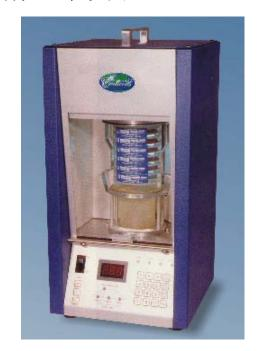
ENDCOTTS SONIC SIFTER 超声波精密筛分仪针对 5Micro 粒径的样品,能在 1min 内完成筛分,具有良好的重现性。独特的筛分动作,依不同样品比重而变化,也可调整频率。垂直空气柱振动每层筛网,持续翻搅样品,缩短通过筛孔的似乎间; 机械式周期性的冲击,针对结块的样品,防止赌赛筛网。该机型最主要的特点在于可保持样品的原有物性,而且不会对筛网产生热河损耗。
