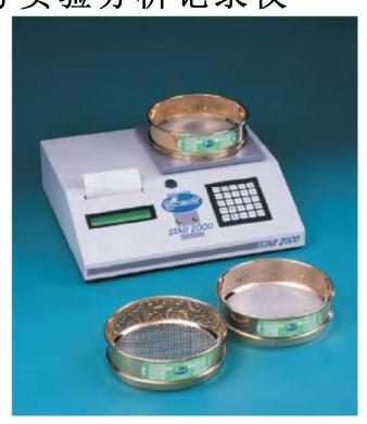
ENDECOTTS STAR 筛分实验分析记录仪以微处理器整合精密天平、打印机及多项功能,成为一部单体式记录仪,可快速分析样品中特定粒径的比例值。在开始筛分前,电脑可预先记录筛网及样品净重,完成筛分时再将各组数据进行记录、打印等,各项繁琐工序全部自动化处理,因此可为多样品分析时节省大量宝贵时间。此外,STAR 可将实验结果储存在仪器中作为比较值(最多可记录 5 组),另可记忆 10 组筛网数据。
