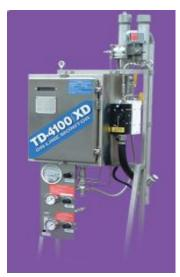
主要特点 非接触式,不受污染的流通池 TD-4100 不带玻璃流通池。 碳氢化合物在经由开放腔 室流入的水流处被检测,水 流不会接触,污染光学窗 口。独家专有的气幕系统能 够在潮湿环境或应用于热 水中时,使光学窗口保持无 雾清晰状态。
