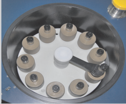
Transform 800俯视图。独特的感应式消解罐设计可以在高通量消解时快速更换内罐。
