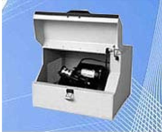
BHY-FM100 冷冻研磨机集强力冲击、研磨及振动等高能动作于一体，研磨罐在周期性往复运动过程中，研磨球高速旋转运动与样品相互撞击，达到研细样品的目的。高效率的研磨机应该能够在较短的时间内向被球磨样品输送较高的机械能量，使被处理的物料在较短时间内完成粉碎，并减少物料的氧化和污染。
