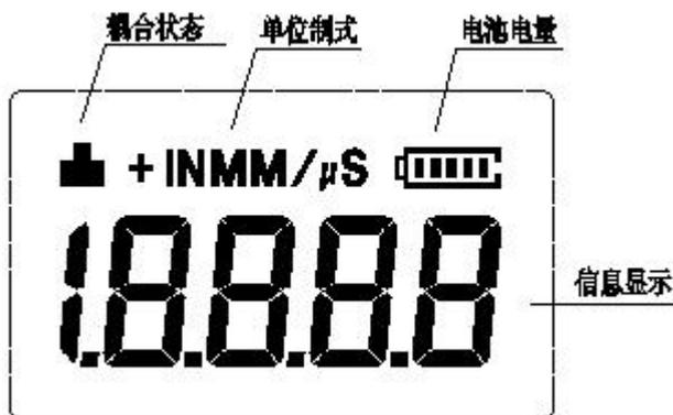
**耦合状态：** 探头与被测工件的耦合状态
