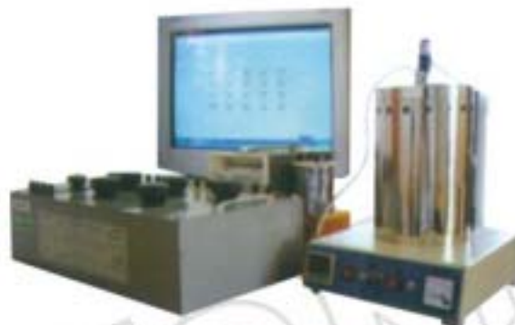
微机监控测定铜电阻温度系数实验
