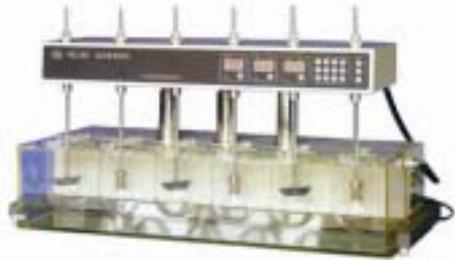
**RC-8D 溶出度测试仪**
