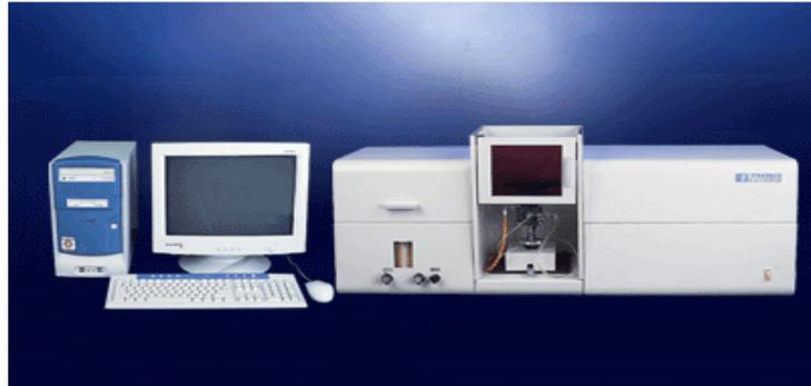
简介:AA2610 型原子吸收能够检测多种微量金属元素,包括铜、铁、钙、铅、汞、铬、镉、金等多种元素。
