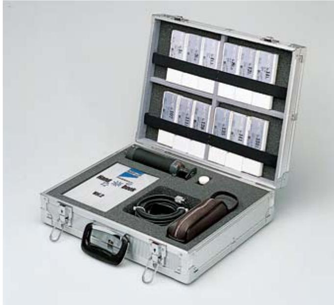
便携式有毒有害气体快速检测箱（进口）符合国家环保总局和国家安全生产办公室相关标准，结合美国环境保护署的有关应急措施要求，可在进入事故现场约 5-15 分钟内即可对常见的 12 种有毒、有害气体进行快速检测，为事故处理提供及时而准确的现场监测数据。快速检测管是一种现场快速、直读测定气体浓度的检测手段，由一支内装显色指示剂、外壁印有浓度刻度的玻璃管组成，当被测气体通过管内指示剂时发生显色化学反应，测试人便可通过变色界线直接读出气体的浓度。检测管及采样设备均具有国家计量器具型式批准证书，并具有美国 SEI 的认证。生产企业通过了 ISO9001 认证。
