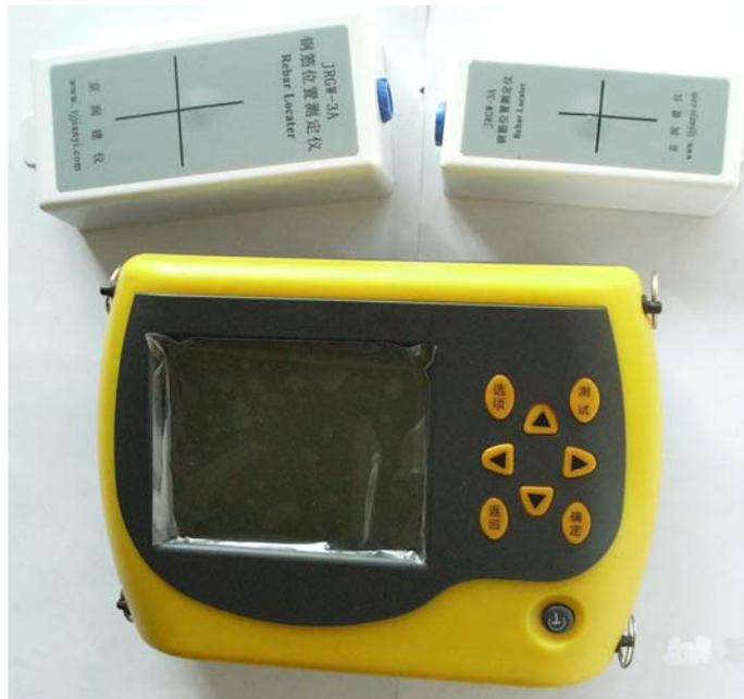
可用于确定钢筋的位置、布筋情况，已知直径检测混凝土保护层厚度，未知直径确定钢筋的位置、布筋情况，已知直径检测混凝土保护层厚度，未知直径同时检测钢筋直径和混凝土保护层厚度。
