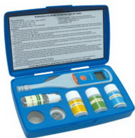
仪器盒：内置校准溶液和备用电池
