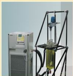
在化工及制药领域, 对玻璃反应釜的有效温度控制
