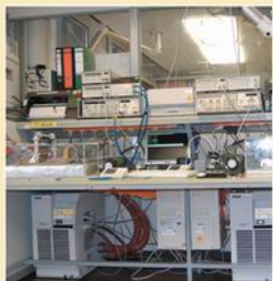
在极低温下, 原材料的快速压力测试
