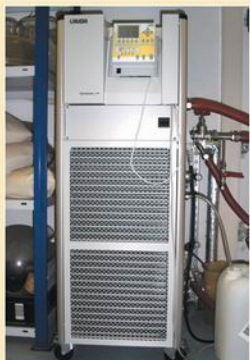
有效节省空间, Integral XT连接外循环设备
