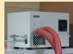
外接高压泵通过连接管可以为工艺过程恒温系统提供双倍压力
