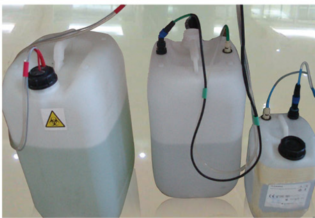
高灵敏液位传感系统： 含系统液传感系统、清洗液传感系统、废液传感及收集系统
