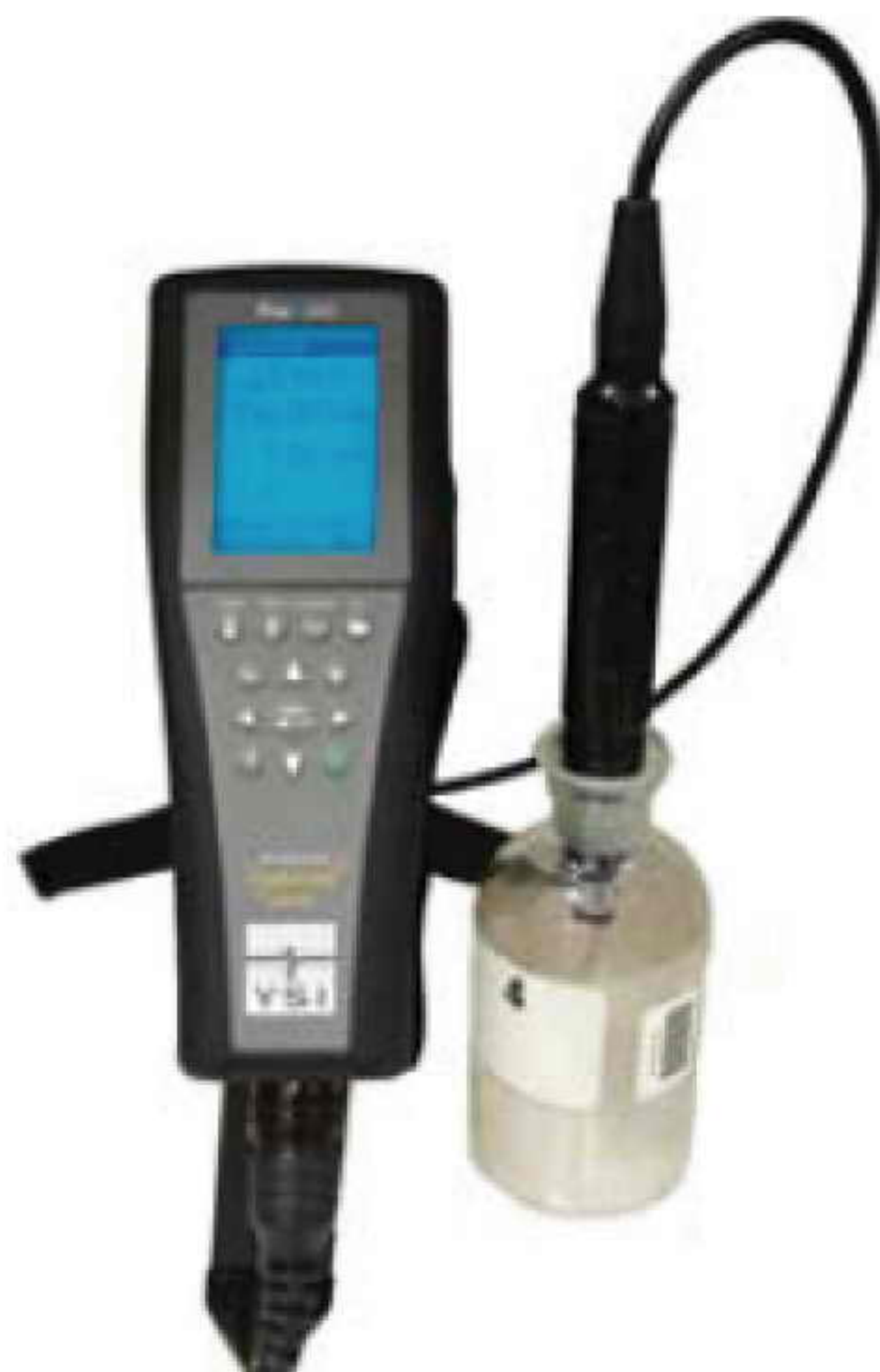
ProODO探头适配标准的300毫升BOD瓶
