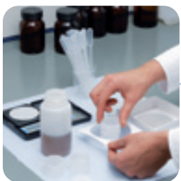
■ 把透明薄膜盖在液体样品杯的底部
