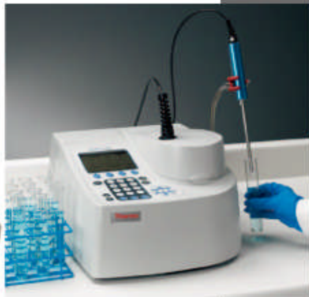
纤维探针增加样品通量, 方便检测小体积、高浓度样品
