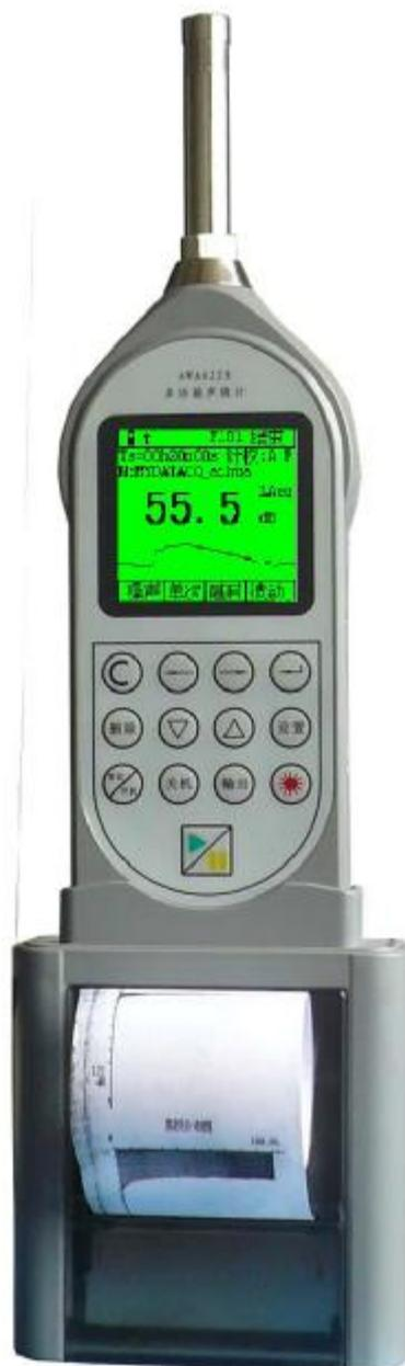
AWA6228 型多功能声级计是采用数字信号处理技术的新一代噪声测量仪器，是 AWA6218 系列的升级换代产品。A、C、Z 三种并行（同时）的频率计权及 F、S、I 三种并行（同时）的时间计权、实时倍频程频谱分析，可以同时测量多种评价指标。仪器具有动态范围大、大容量存贮、录音、U 盘、读卡器等功能。模块化设计，用户可以根据需要选购相应的模块。还可选配内嵌 GPS 定位系统，测量噪声的同时，提供位置信息及测点运动速度；选配微型打印机，可现场打印测量结果；选配 GSM 无线数据传输模块，可通过 SMS(短信)将测量结果发到指定的手机或计算机上。该仪器可广泛应用在环境保护、劳动卫生、工业企业、科研教学等领域，完成环境噪声测量、机场噪声测量、声功率级测量、机器设备噪声测量以及建筑声学测量。完全符合 GB3096-2008 声环境质量标准、GB12348-2008 工业企业厂界噪声排放标准、GB22337-2008 社会生活环境噪声排放标准中对测量仪器的要求。
