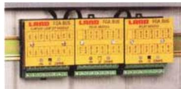
讯总线对所有组成模块进行基本控制和监视。基于这种设计原则，新增模块可以很方便的添加到系统中。控制系统将不断对所有模块进行例行检查，保证系统的完整性并提供快速、自动的诊断服务
