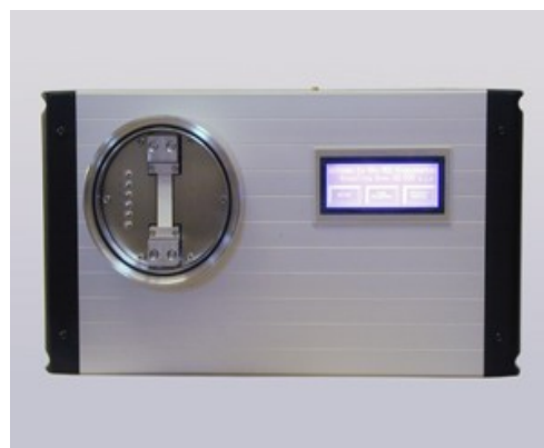
AO 500 顶视图，左侧为观察窗，右侧为触摸屏
