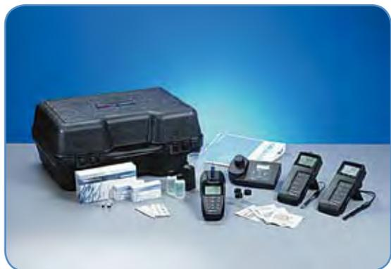
AQ4EK1 移动实验室水质分析仪是 Thermo Scientific 公司为自来水和环保检测工作者专门推出，各项测试集为一体，方便于户外水质分析的成套组合设备。
