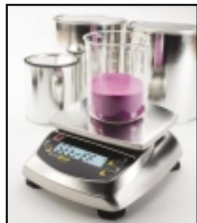
**比重称量** – 无需人工计算即可简单快速的测定样品的比重。此模式不仅可以用于关键材料的检验，在食品加工与食品服务应用中，对于混合物中发泡率的检验也同样有效。在该模式下，先将纯净水倒入容器中得出纯净水的重量，再用相同体积的样品替换掉容器中的纯净水，而后天平将显示样品的比重。
