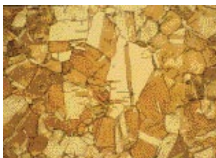
纯铜， 试样采用氯化铜和氨蚀刻， 放大100倍。
