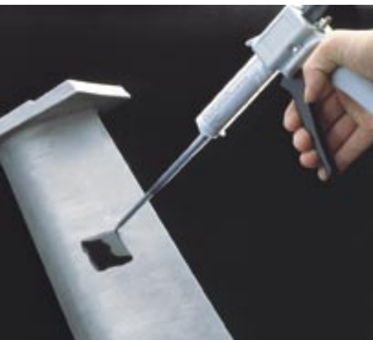
操作人员将RepliSet涂抹到试样上。
