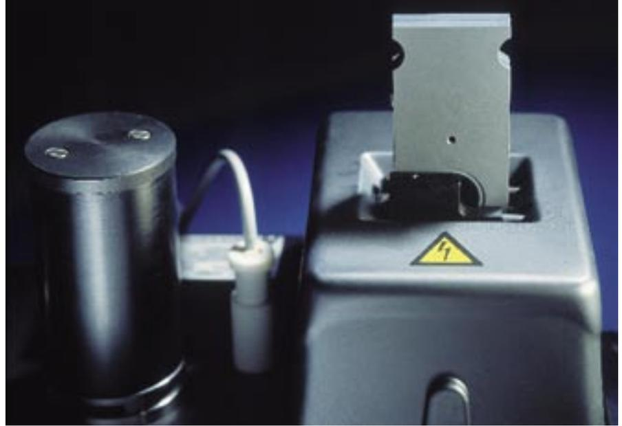
抛光单元配有电解液泵、电子温度计和可交换试样夹具座。
