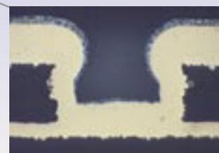
各种行业的主要标准均要求对PCB镀通孔进行金相分析。因此需制样，以便在显微镜下对镀通孔进行准确的孔心检查。随着HDI技术与微孔的出现，电路板检查成为一项复杂的任务。制样过程涉及了一系列步骤，每司一步骤都对系统精度的保持增加了困难。特尔ViaSampling系统直面挑战，不仅可提高精度，还可提高生产率。
