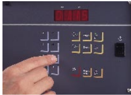
通过触控键盘便于对各制样参数进行设定
