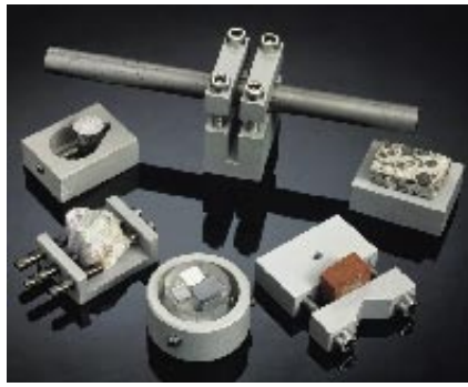
Minitom配有适用于所有试样形状的试样座
