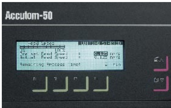
切割过程开始后，显示屏开始变化并显示相关参数
