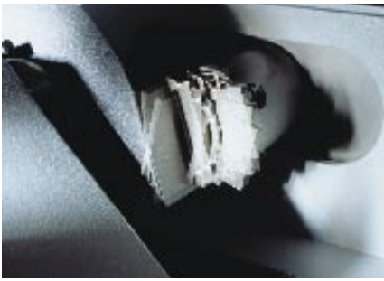
振动切割一般用于长方形试样，可显著缩短切割时间。
