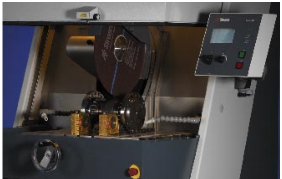
可转动控制面板上集成了一个大型图形显示屏，并带有两个使用方便的操作键
