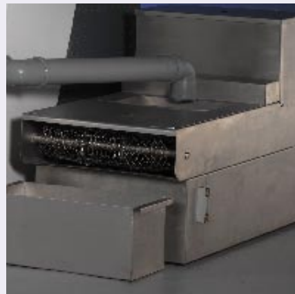
切割工作量很大时推荐使用带式过滤冷却装置。
