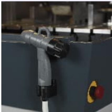
Exotom-150的冲洗枪放置在切断室外。
