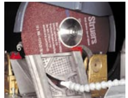
用两个柔性水管增强冷却效果，适用于空心工件。
