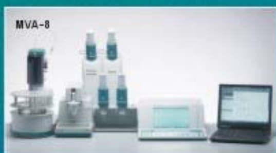
MVA-8 全自动伏安极谱仪系统 1x746 VA Trace Analyzer 伏安极谱仪主机 1x747 VA Standard 工作站 1x813 VA Autosampler 自动进样器 4x700 Dostko 配液器 1xVA Database 2软件 自动添加标准溶液、辅助溶液，自动冲洗、排液，自动、定标分析多达18个样品。
