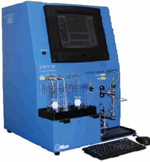
符合国家标准 GB/T9169 喷气燃料热氧化安定性测定法 (JFTOT 法)
