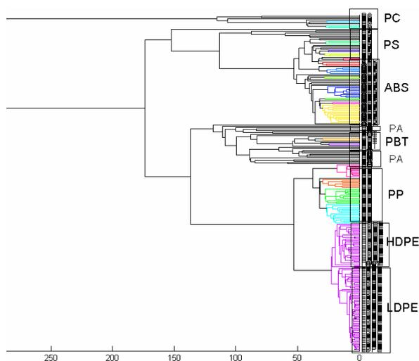
或者，测试数据可以通过聚类图来表示，多维矩阵中的每种颜色代表一种特定聚合物，以下的图表只显示了两维的情况，但清楚地表示出了归类情况:-
