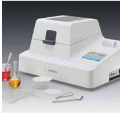
如果样品含水量较大，微波干燥则是水份测定中最快速最有效的加热干燥方法。LMA200P 可以检测大约 8% 到 100% 的水份含量，而需要的时间比起其它热重方法所需时间少得多，平均只需要 40-120 秒。集中发射的微波能通过样品室下部两个孔垂直通过圆柱体。这样能让微波能量集中在样品上。在测试过程中，样品盘旋转样品，使微波能量平均分布。这样能防止传统微波分析中常见的热点和冷点的产生。
