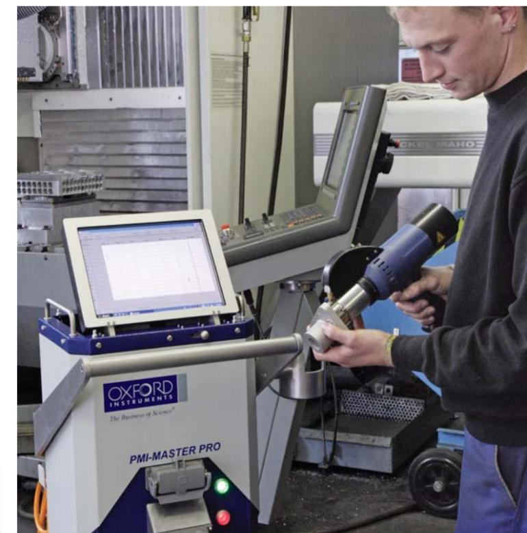
智能化的光学系统可通过每次激发测量自动调节光路，将操作者从繁琐的光路校准中解放出来。并且 PMI-MASTER PRO 开机即可用，无需预热。
