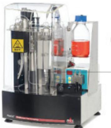
FlowCAT是设计紧凑的台式反应釜产品，可以实现高压流动化学反应的具体实验情况模拟。灵活性极高的设计，充分实现均质或非均质化学物质在同一反应单元中的快速筛选、流程优化、工艺改进与安全放大等应用需求，并且可以拓展单路或多路气体或液体进料。FlowCAT可实现以下多种应用，并且可在其中自由快速切换
