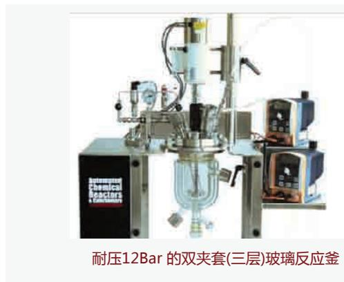
耐压12Bar 的双夹套(三层)玻璃反应釜
