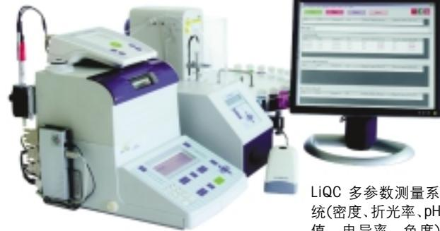
LiQC 多参数测量系统(密度、折光率、pH 值、电导率、色度)
