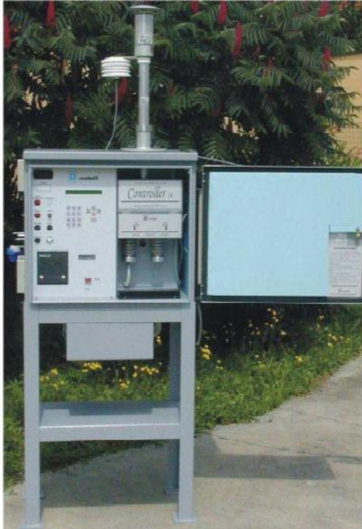
赞贝利有限公司提议建立一种新型顺序标准空气颗粒物监测系统，用于细尘采样：PM10、PM2.5 和 PM1 用于测定某封闭区、市区或郊区的环境影响。该系统柜完全绝缘，带风扇，并具有热变电阻和空气调节器或标准版 Peltier（模块集成温度控制器）。
