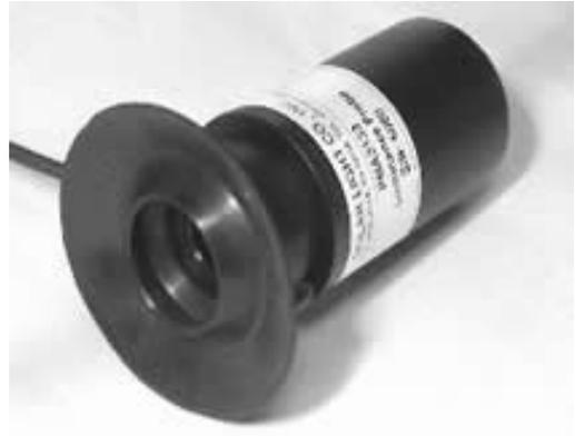
PMA2133 是一款符合 CIE 适光光谱响应的便携式亮度探测器。该探测器的光谱响应类似于人眼对适光区域的视觉响应。
