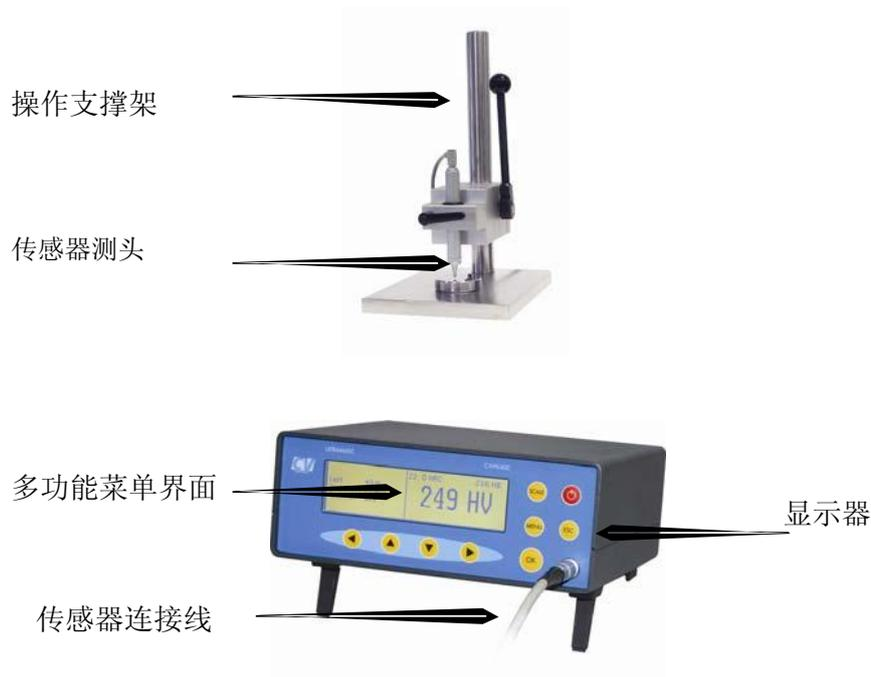
宝禾 CV-HV400 采用先进的超声波谐振测试原理进行自动维氏硬度测量，只需将测头接触工件表面轻轻往下压（测头本身的压力是恒定的，不会受操作者施力的影响），数据就直观地在显示器上显示出来。
