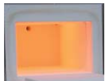
所有面加热的陶瓷马弗腔
